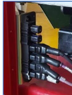
L'extrémité du câble 3312107 doit être connectée au connecteur multiliaison de la grue.
