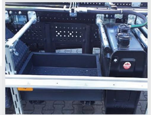
Durch das geschraubte Befestigungssystem schneller und problemloser Anbau von Zubehör. Tank oder seitlicher Unterfahrschutz z.B. werden einfach angeschraubt.
