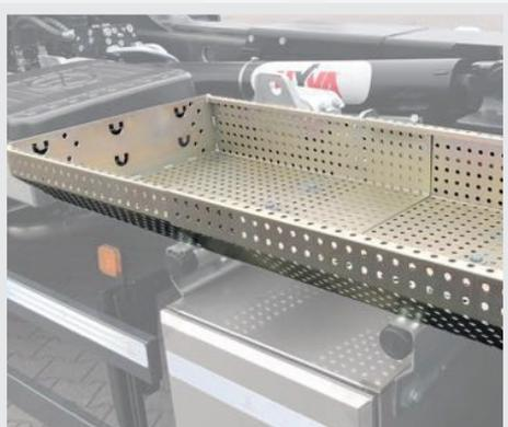
Mit dem in der Länge verstellbaren Netzkasten lässt sich der verfügbare Platz am LKW-Fahrgestell gut nutzen.
