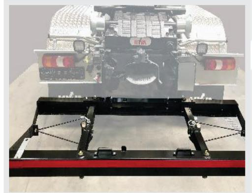
Unterfahrschutz mit Scherenmechanik manuell oder hydraulisch betätigt.
