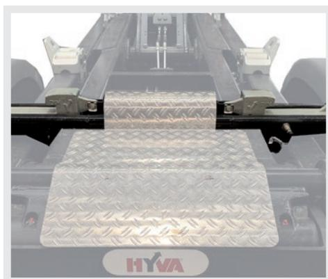
Hochfeste hydraulische Universal-Containerverriegelung, leicht austauschbar von innen nach außen und umgekehrt.
