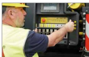
Krane mit manuellen sequentiellen Steuerungen haben Hebel auf beiden Seiten des Krans. An jeder Steuerung kann die Ausrichtung der Steuerelemente von oben nach unten oder von links nach rechts gleich sein.
