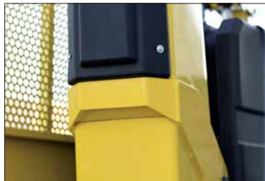
Robuste Säulenkonstruktion und Schlauchabdeckung
