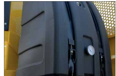
Großer Öltank aus Materialien in Sandwichstruktur (PEX und PA6)
