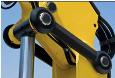
Geschmiedete Kniehebel an Säule und zweitem Ausleger
