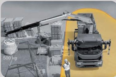
Dieses System optimiert erstmals auf Lkw-montierten Gelenkkränen die Abstützung und macht den Kranbetrieb sicherer und effizienter. Es erlaubt es dem Fahrer, die Kran-Hubkraft im Voraus auf der Grundlage der Stabilität des Fahrzeugs zu überprüfen. Eine grafische Darstellung zeigt die bei der gewählten Last mögliche Reichweite und die aktuelle Schwenkposition des Auslegers.
