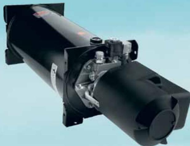
Para veículos pesados basculantes, com sistemas basculantes de 3 vias, a Hyva disponibiliza cilindros das séries KRA e KRM. Graças ao seu design único, estes cilindros são caracterizados por um comprimento fechado muito curto e dimensões incorporadas. Estes cilindros são fornecidos com uma base de 3 vias para serviço pesado, com válvula de corte integrada. A elevada qualidade de produção, com opção de segmentos cromados endurecidos, garante uma longa vida útil.
