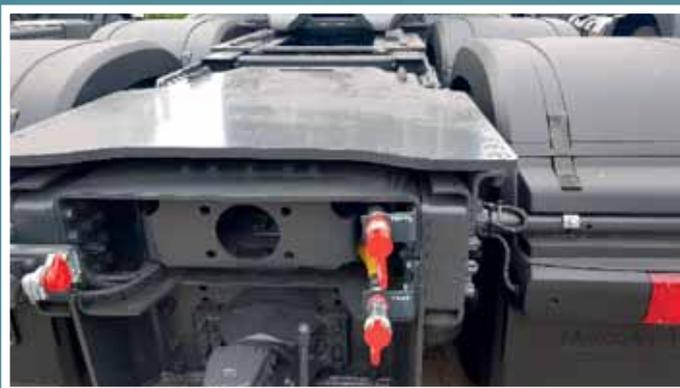
Válvula de basculamento montada no filtro de retorno
