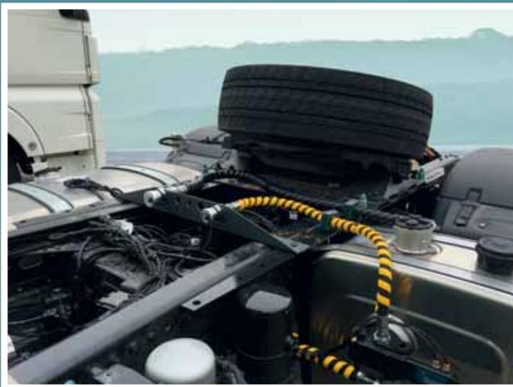
**Suporte de fixação para acoplamentos de desengate rápido**
