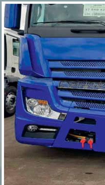
**Acoplamentos de desengate rápido na dianteira do trator**
