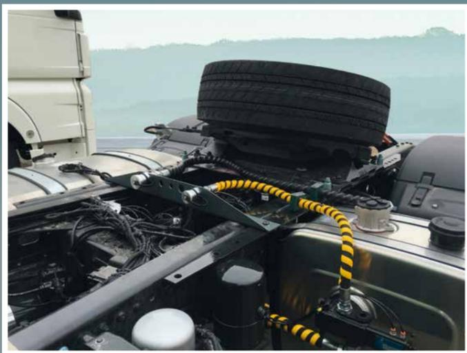
Staffa di montaggio per attacchi a innesto rapido
