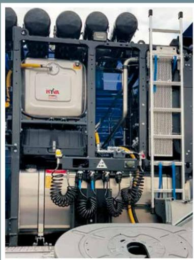
Serbatoio dell'olio dietro la cabina di una motrice a 4 assali
