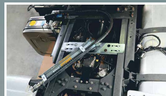
Réservoir SM avec bras de guidage de flexible Flexsaver Easy
