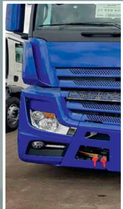
**Raccords à dégageur rapide à l'avant du tracteur**
