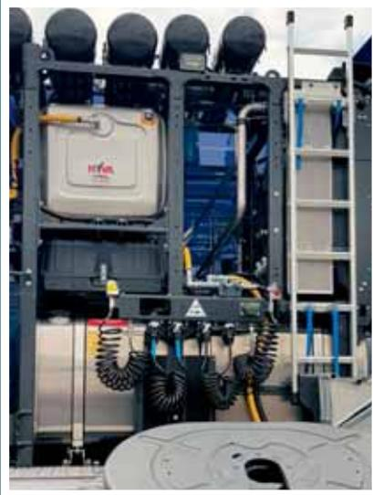
**Depósito de aceite tras cabina en unidad de tractor de 4 ejes**
