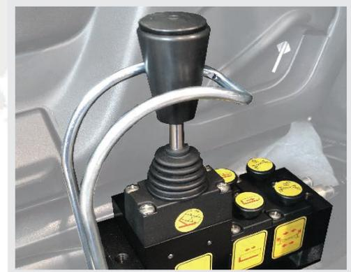
Durch die pneumatische Bedienung im Fahrerhaus (ohne Elektronik) ist das System sehr zuverlässig.
