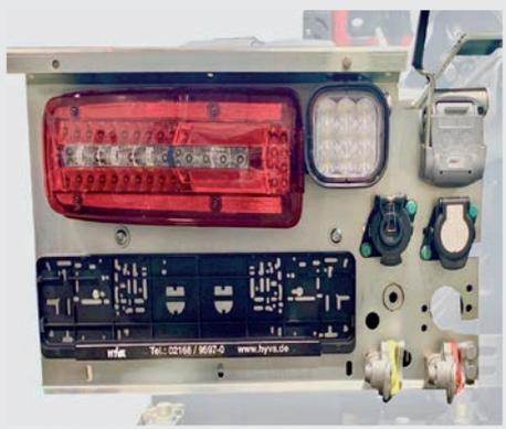
Die verzinkten Montagekonsolen für alle benötigten Anschlüsse und Fahrzeugleuchten sorgen für Ordnung am Fahrzeug.
