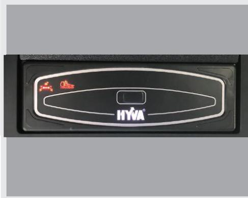
Die Position der hydraulischen Containerverriegelung und weitere sicherheitsrelevante Funktionen werden dem Bediener im Fahrerhaus angezeigt.
