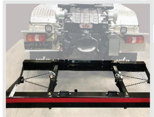
Unterfahrerschutz mit Scherenmechanik manuell oder hydraulisch betätigt.
