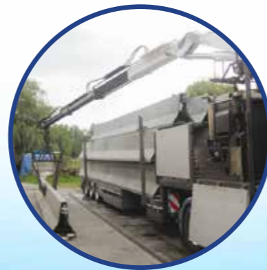
Manutention de barrières routières
