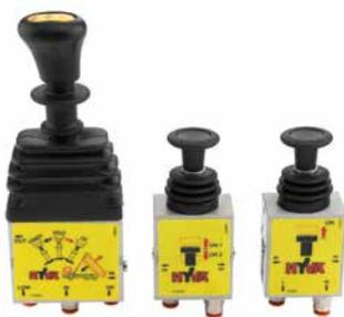
Os controlos com múltiplas secções são utilizados para controlar o cilindro basculante e uma série de funções adicionais, como abertura da porta traseira, sistemas de cobertura, placas laterais e outras. A Hyva disponibiliza conjuntos de controladores que podem ser criados de acordo com as necessidades de uma determinada aplicação e para o número necessário de secções de controlo.
