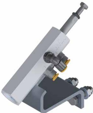
A válvula de corte STD está montada na base do cilindro, sendo fornecida com um suporte especial para possibilitar uma instalação fácil e um ajuste preciso deste limitador. É operada pneumáticamente, o ajuste mecânico possibilita que seja utilizada com a gama completa de cilindros frontais da Hyva. A utilização desta válvula garante uma operação precisa e uma limitação suave do curso, o que resulta num aumento significativo da vida útil do cilindro e do kit hidráulico.
